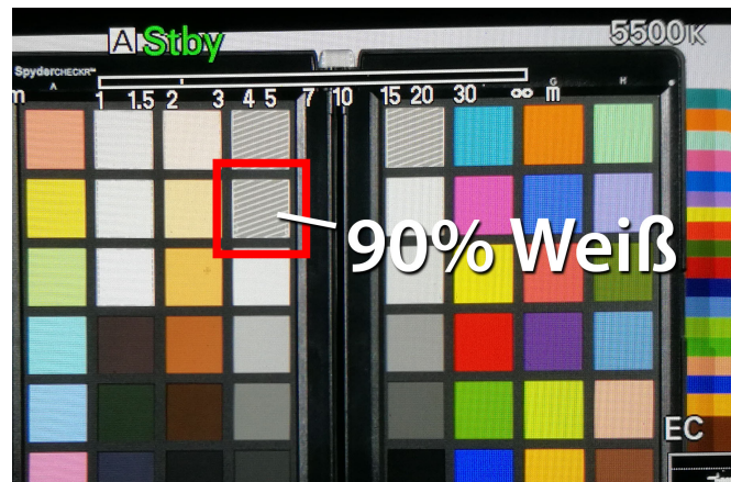
Abbildung 55: Zebra2-Anzeige weist auf korrekte Belichtung von 90 IRE des 90%-Weiß-Feldes hin.
