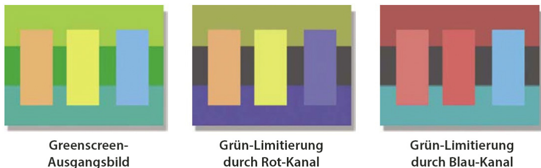
Abbildung 9: Links: Ausgangs-Testbild. Mitte: Ergebnis einer Despill-Operation, wenn der Grün-Kanal max. den Wert des Rotkanals annimmt. Rechts: Ergebnis einer Despill-Operation, wenn der Grün-Kanal max. den Wert des Blaukanals annimmt (Wright, 2010, S. 94).
